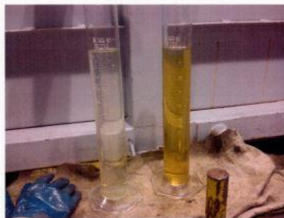
Рис.3 Результат отбора проб при обводненности рабочей жидкости 8%
