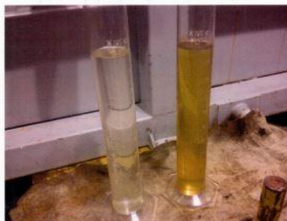
Рис.2 Результат отбора проб при обводненности рабочей жидкости 88%
